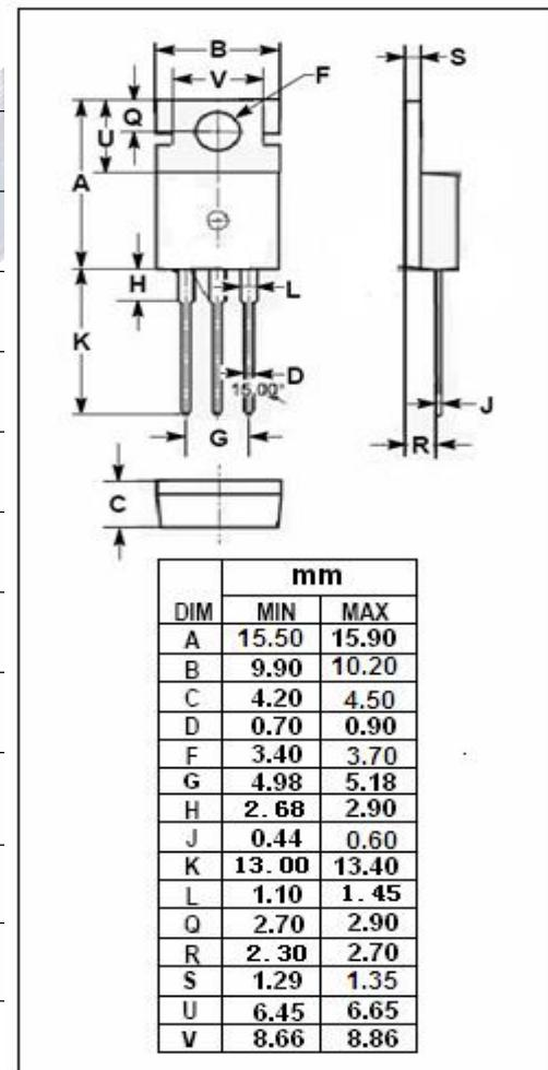
**isc N-Channel MOSFET Transistor****IRFB7546,IIRFB7546****ELECTRICAL CHARACTERISTICS** $T_c=25^\circ\text{C}$  unless otherwise specified
