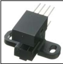
KE204は、高出力赤外発光ダイオードとフォトICを組み合わせた透過型フォトインタラプタ形状のエンコーダモジュールです。高性能、高信頼性の回転検出システムの構成が容易で、機器の小型化をはかることができます。
