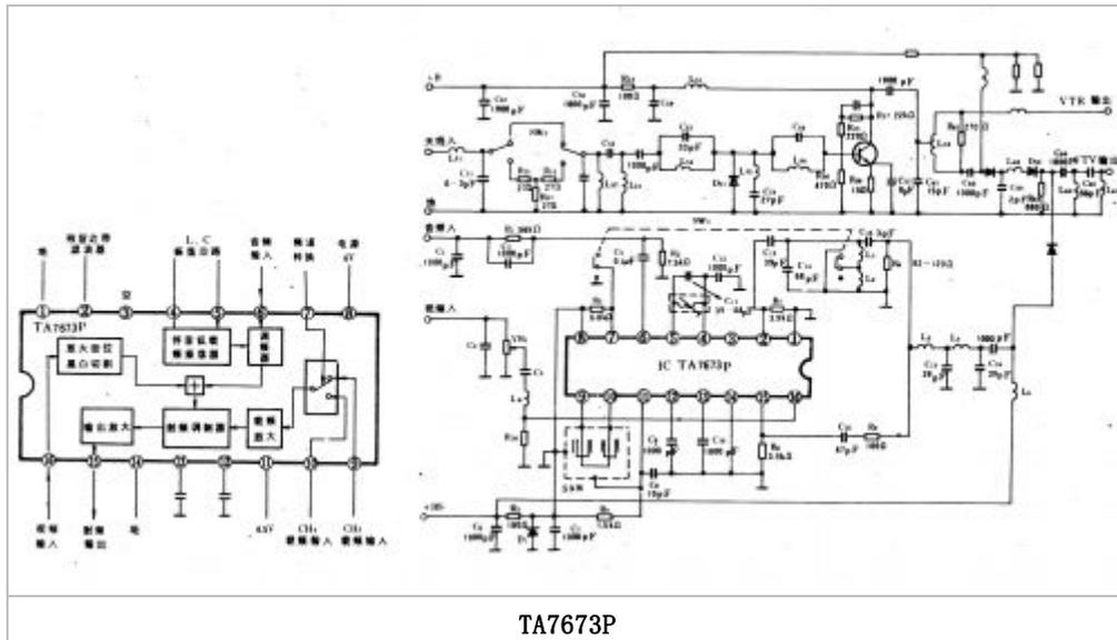
同类直接代换型号：UPCI507C、UPCI507。（新型号TA8637为替换型）
