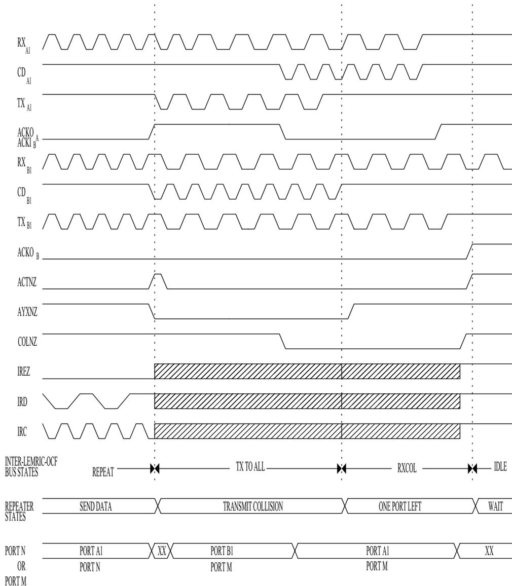
**FIGURE 12. Transmit Collision**
