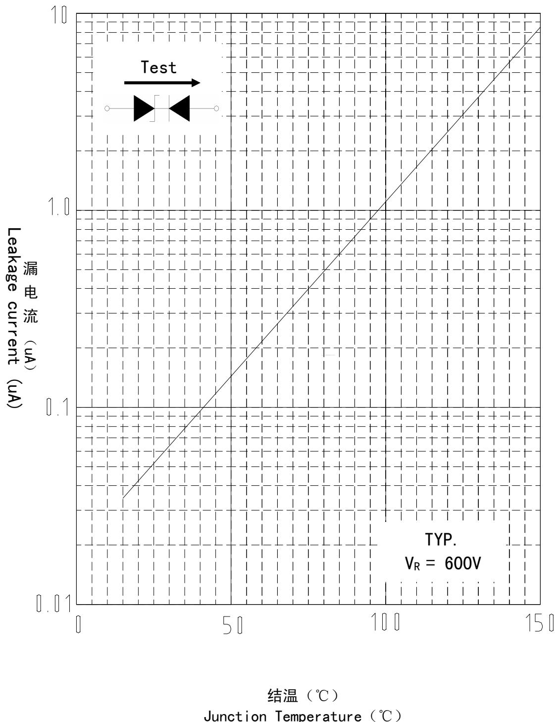
图 3- Zener 漏电流温度曲线
